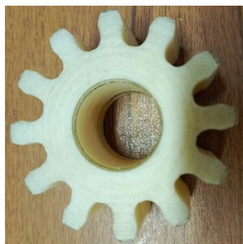
Рис. 3.7.4. Зубчатое колесо с подрезанными зубьями
