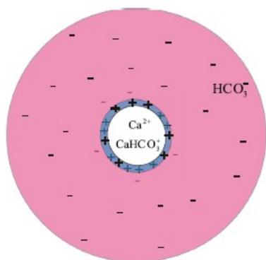
Рисунок 2. Строение двойного электрического слоя коллоидной частицы
