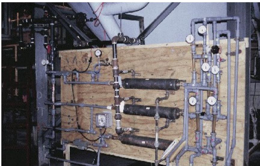
Рисунок 4. Испытательный стенд, собранный на теплоцентрали Рок-Аленд Арсенал (Rock Island Arsenal Steam Plant)
