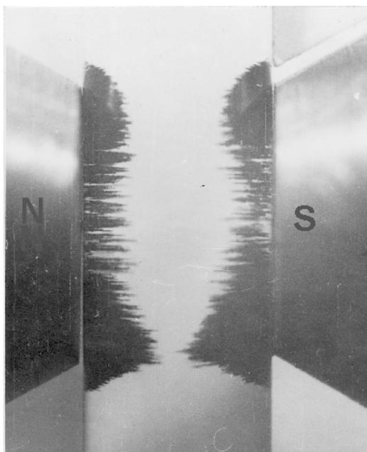
Рисунок 3. Фотография слоя ферромагнитных примесей, задерживаемых из протекающей воды в зазоре электромагнитного аппарата
