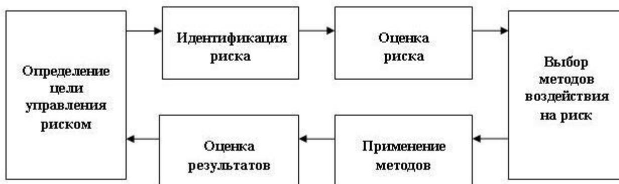
Рисунок 1. Схема взаимосвязи этапов управления риском на предприятии
