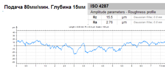
Рисунок 3. Поверхность реза образца из а) - стали 30ХГСА при подаче от 85 до 125 мм/мин, б) – алюминиевого сплава Д16Т при подаче от 85 до 120мм/мин, в) – из композиционного материала стеклопластик – титан при подаче от 85 до 125 мм/мин, г) – профилограмма поверхности реза образца из стали 30ХГСА на глубине измерения 15мм при подаче 80мм/мин.
