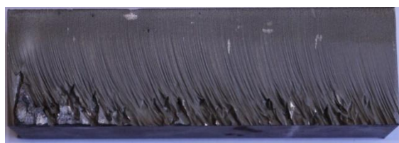
Рисунок 2. Схема разделения реза на зоны гладкого и волнистого реза.
