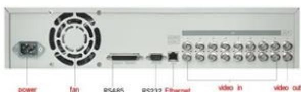
Рисунок 23. Цифровой триплексный видеорегистратор DVR1604 (вид спереди)
