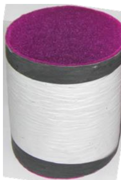
Рисунок 2. Композитная оболочка из углеродных нитей с внешней металлизированной и внутренней флокированной поверхностью
