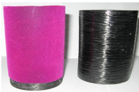
Рисунок. 1. Композитные цилиндрические оболочки из углеродных нитей, модифицированные волокнами разной природы на внешней и внутренней поверхности
