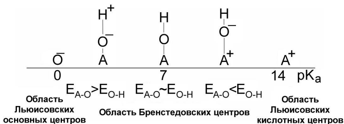
Рисунок 1. Схема донорно-акцепторных центров на частично гидратированной поверхности кислородсодержащих твердых соединений [5–7].
