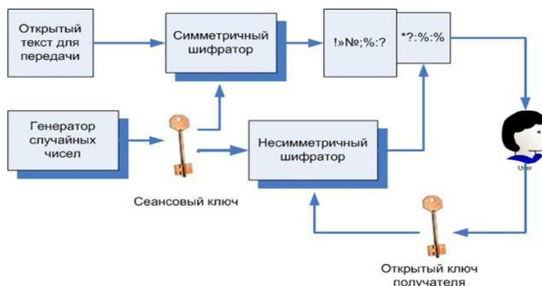
Рисунок 7. Схема комбинированного шифрования
