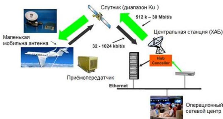
Рисунок 17. Устройство передачи бортовой информации в операционный центр, с помощью ССС
