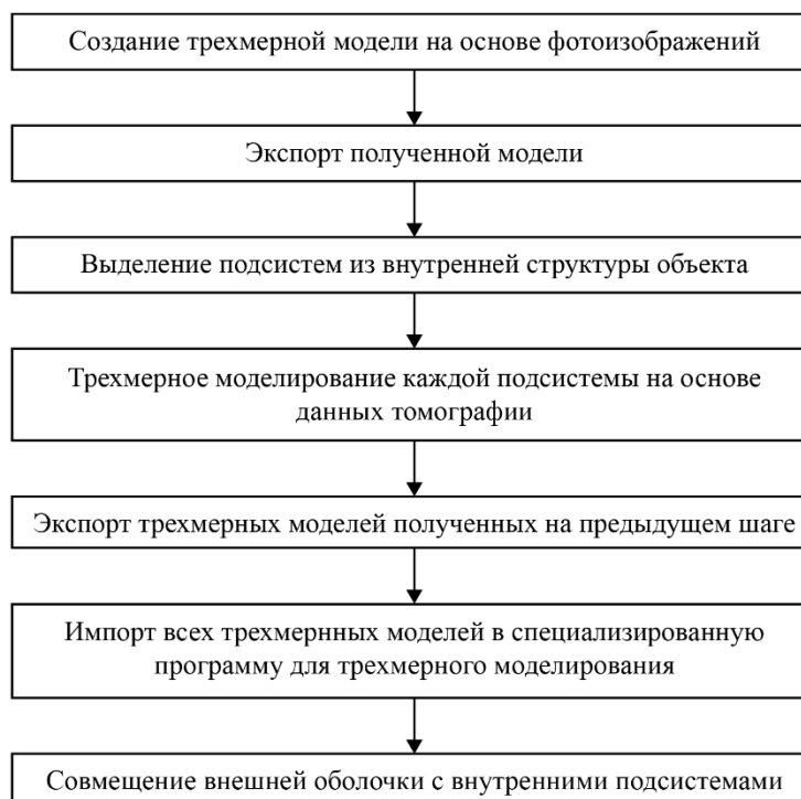
Рисунок 3. Общий алгоритм получения трехмерной модели объекта, включающей внешнее и внутреннее строение.
