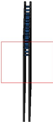
Рисунок 2. Вид промежуточной опоры в программе Лира в 3D пространстве
