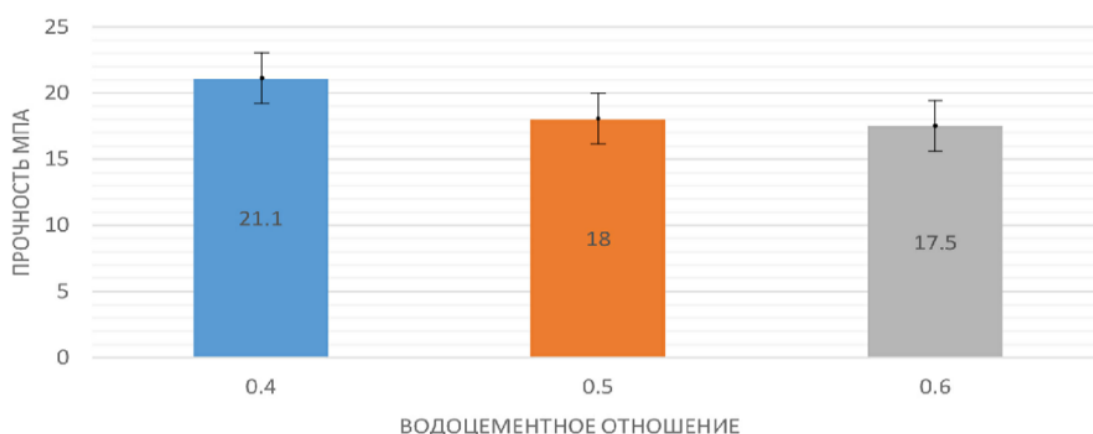
Рисунок 2. Зависимость прочности образцов от водоцементного отношения
