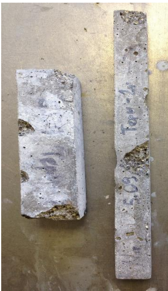
Рисунок 3. Образцы после испытания на щелочно-силикатное взаимодействие
