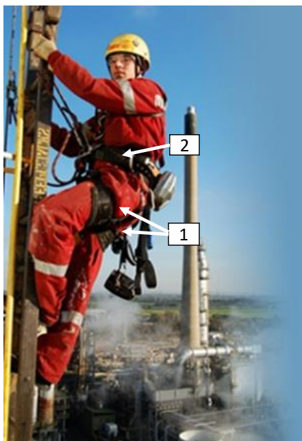
Рисунок 3. Промышленный альпинист в рабочее время, 1-набедренные ремни, 2 поясной ремень
