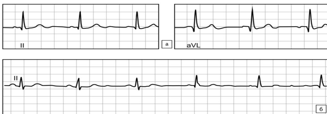
Рисунок 4. Примеры записей ЭКГ, полученных с помощью датчиков ERIS (а) и традиционных «мокрых» электродов (б)
