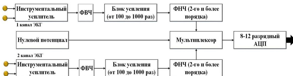
Рисунок 2. Структурная схема аналоговой части системы мониторинга ЭКГ
