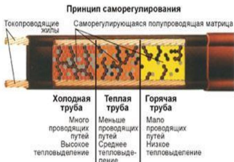
Рисунок 1. Принцип саморегулирования нагрева греющих кабелей
