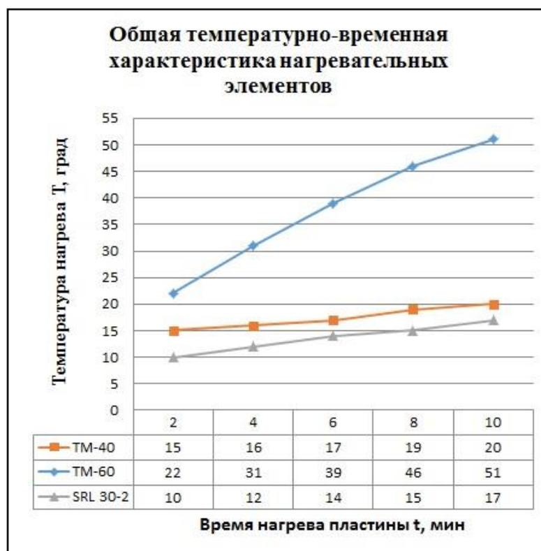
Рисунок 2. Общая температурно-временная характеристика нагревательных элементов
