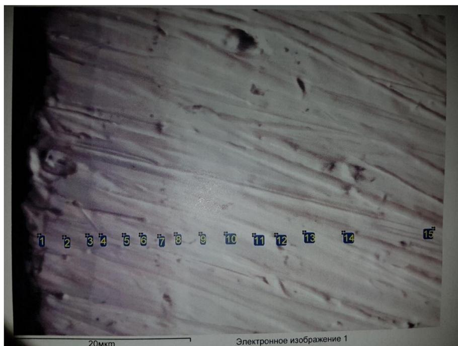
Рисунок 2. Поперечное сечение образца стали 30ХНЗ
